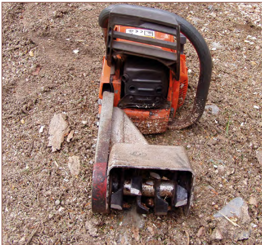
Obr. 3: Detail odkorňovacího adaptéru (frézy)
