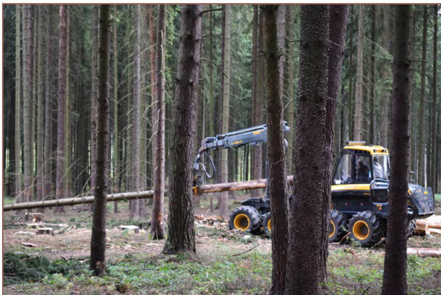
Obr. 4: Odkorňování pomocí harvestoru se speciálně upravenou hlaví
